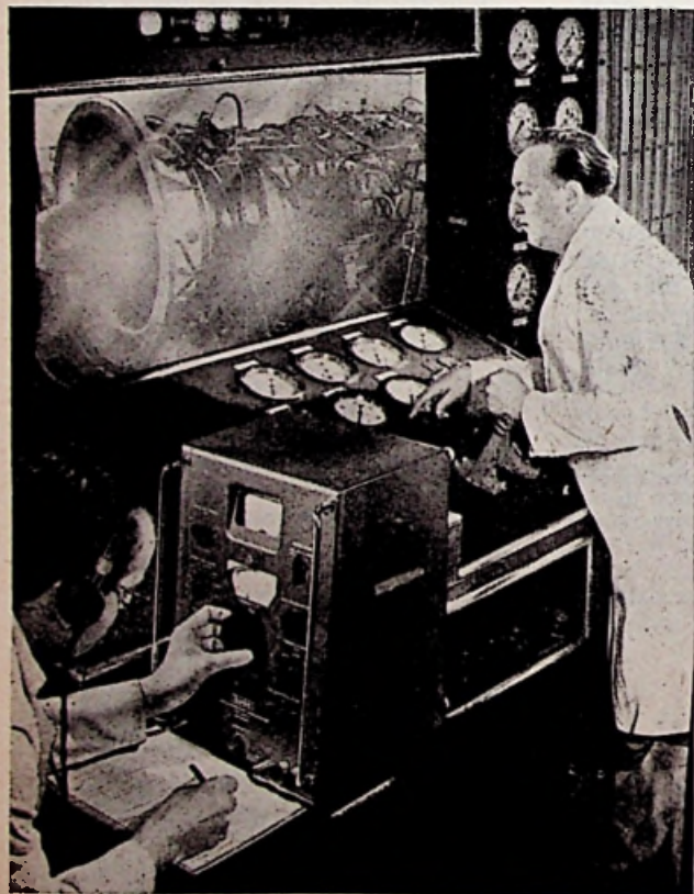
TESTEN VAN EEN „SAPPHIRE“ STRAALMOTOR bij Armstrong Sიდდely Motors. Op de voorgrond de wave analyser type D-489
